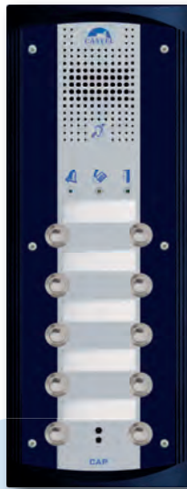
CAPH 10B Portier audio 10 boutons d'appel conforme loi Handicap REF 660.0500
